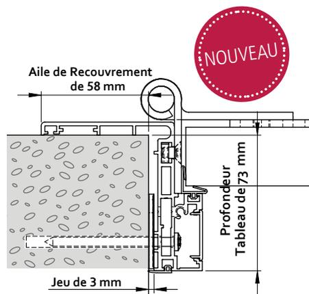
L'aile de recouvrement permet de compenser les faux aplombs de la maçonnerie et de masquer la plupart du temps les anciens gonds tronçonnés.
